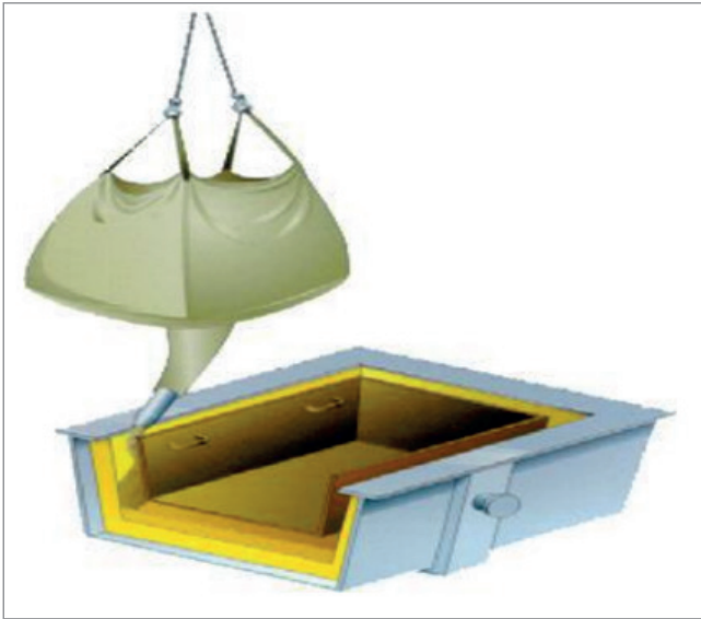
Рис. 1. Метод выполнения рабочей футеровки промежуточных ковшей МНЛЗ сухой массой
