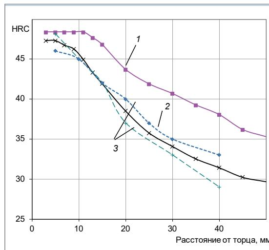
Рис. 4. Прокаливаемость образца стали 21ХГНМБА из проката № 1:
