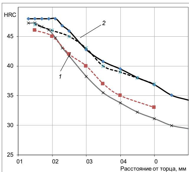
Рис. 6. Прокаливаемость стали 21ХГНМБА: 1 – прокат № 1; 2 – прокат № 2
