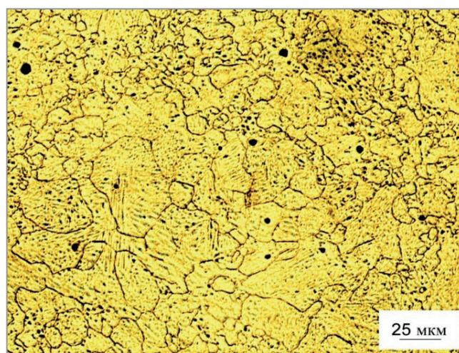
Рис. 7. Структура сердцевины зубьев зубчатых колес из проката № 2
