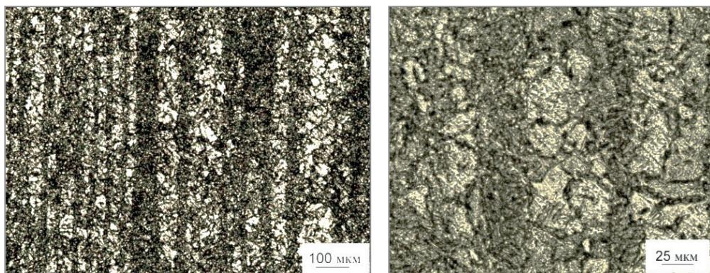
Рис. 1. Микроструктура образца проката № 1 стали 21ХГНМБА производства ЧАО «Днепропресссталь», травление в 4%-ном растворе азотной кислоты
