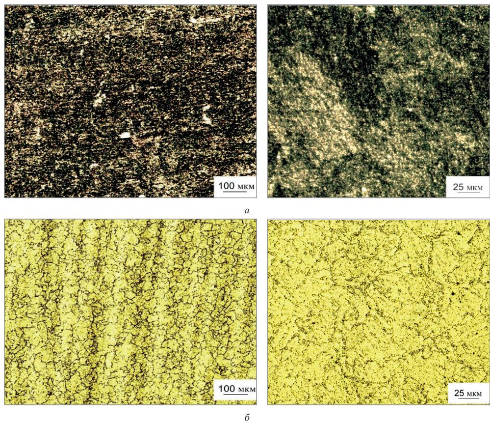
Рис. 2. Микроструктура образца проката № 2 стали 21ХГНМБА:
