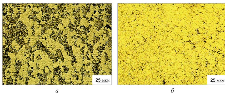
Рис. 3. Микроструктура торцовых образцов проката № 1 (а) и проката № 2 (б),
