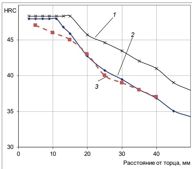
Рис. 5. Прокаливаемость образца стали 21ХГНМБА-В из проката № 2:
