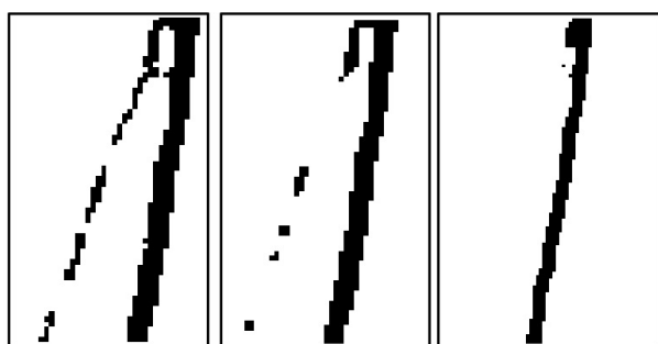
Рисунок 12. Результат морфологических операций и медианной фильтрации: a – фрагмент бинарного изображения подписи (база CEDAR) после морфологических операций, б – результат морфологических операций и медианной фильтрации (3x3), в – результат морфологических операций и медианной фильтрации (5x5)
