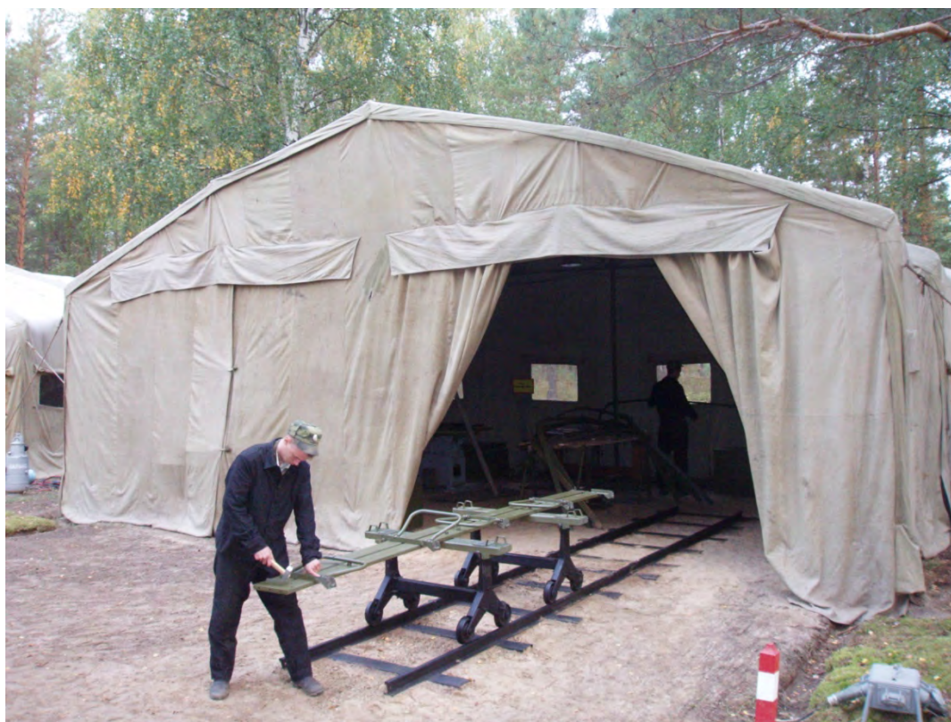
Рис. 2.43. Размещение оборудования отделения деревообделочных, обойных и малярных работ в производственной палатке ПЗ8 (6×10 м)
