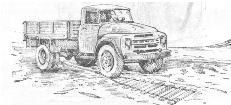
Рис. 3.30. Самовытаскивание автомобиля с помощью колеяной дорожки
