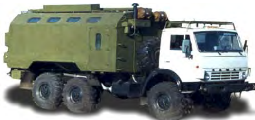
Рис. 1.6. Мастерская МТО-АМ на шасси автомобиля КамАЗ-43101
