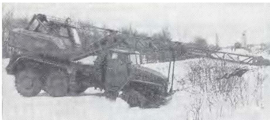
Рис. 3.3. Легкое застревание автомобиля КрАЗ-214 в заснеженном овраге
