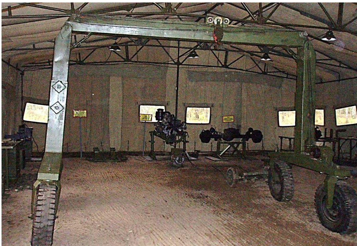
Рис. 2.42. Размещение оборудования отделения разборочно-сборочных работ и текущего ремонта агрегатов в производственной палатке ПЗ8 (12×10 м)
