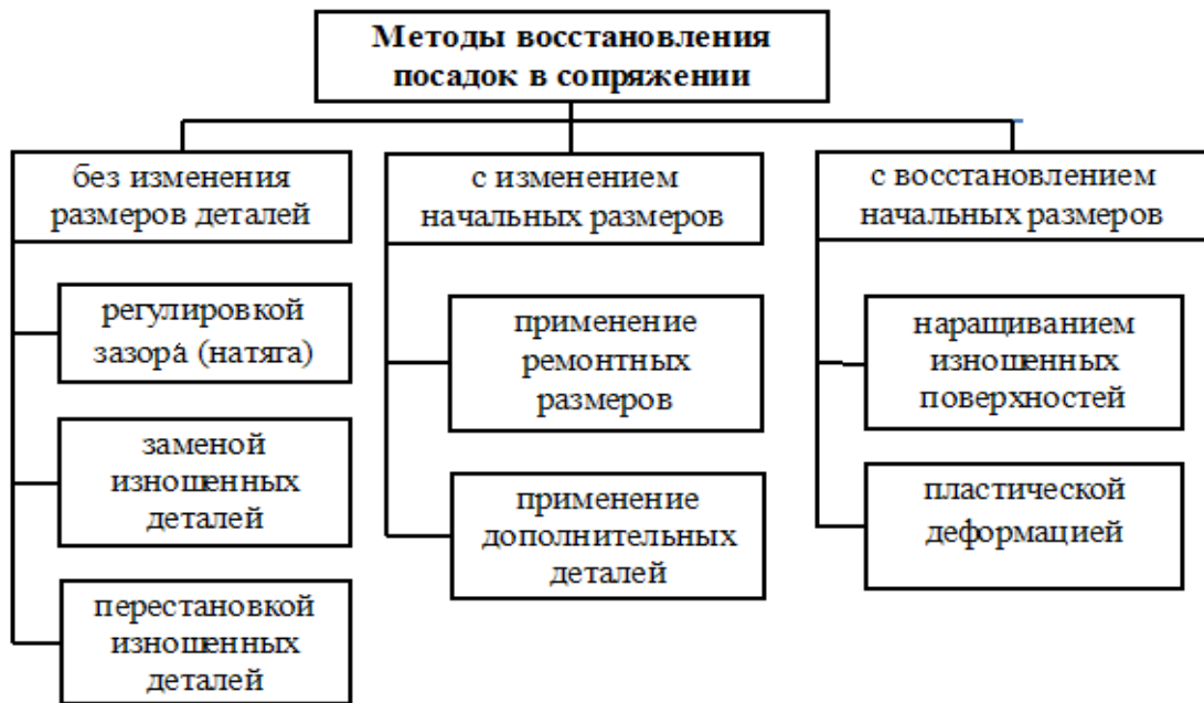
Рис. 4.1. Методы восстановления посадок в сопряжении
