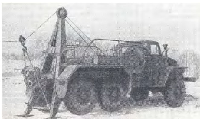
Рис. 3.36. Установка понизителя троса лебедки
