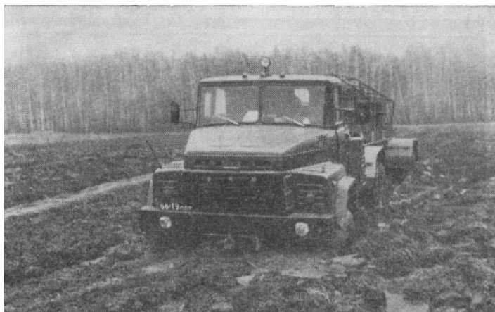
Рис 3.2. Легкое застревание автопоезда КрАЗ-260Д-8392 на размокшей пахоте в период осенней распутицы
