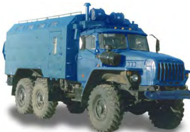
Рис. П5.3. Мастерская ремонтно-механическая МРМ-МЗ.1
