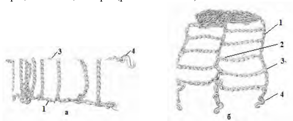
Рис. 3.8. Цепи противоскольжения: а – для одинарных колес; б – для двойных колес; 1 – продольная цепь; 2 – поперечная цепь; 3 – соединительное звено; 4 – замок
