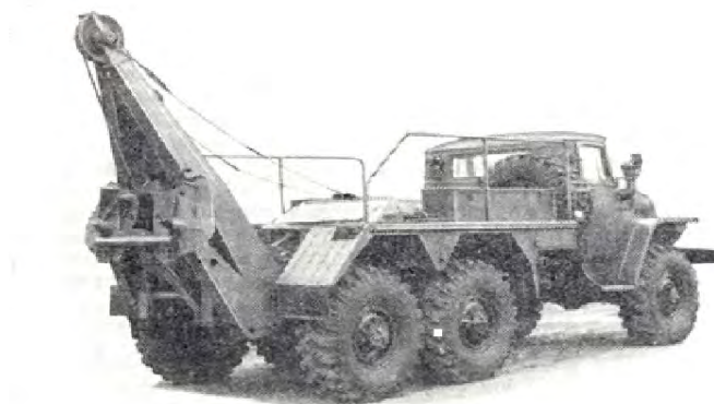
Рис. 3.20. Легкий колесный эвакуационный тягач КЭТ-Л модели ТК5В
