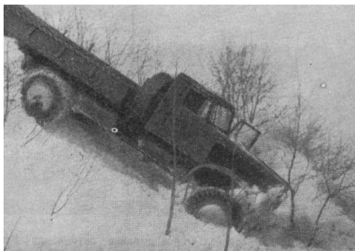
Рис. 3.3. Легкое застревание автомобиля КрАЗ-214 в заснеженном овраге
