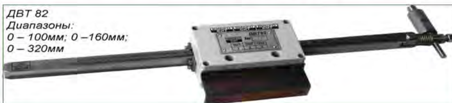
Рисунок 3.4. Датчики и преобразователи относительного виброперемещения и смещений.
