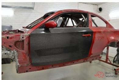
Рисунок 1 – Применение углепластика
