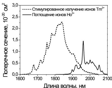
Рисунок 2 – Спектры поперечных сечений стимулированного излучения ионов  $\text{Tm}^{3+}$  и поглощения ионов  $\text{Ho}^{3+}$  в кристалле KYW
