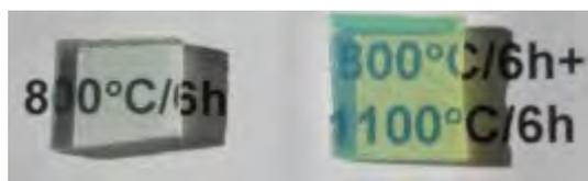
Рисунок 3 – Фотография прозрачной стеклокерамики с нанокристаллами ганита  $\text{Ni}^{2+}:\text{ZnAl}_2\text{O}_4$
