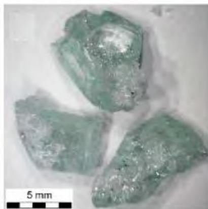
Рисунок 1 – Фотография синтезированных монокристаллов  $\text{CsCdCl}_3$  с ионами  $\text{Bi}^+$
