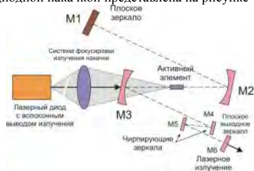
Рисунок 1 – Схема фемтосекундного \text{Yb}:\text{KYW} лазера с диодной накачкой
