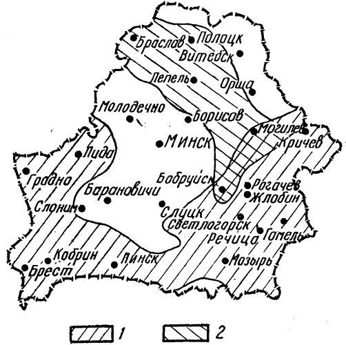
Рис. 2. Районы возможного применения бесфильтровых скважин в песках на территории Белоруссии:
