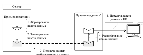
Рисунок 1 – Схема зашифрованной передачи информации в сенсорной сети
