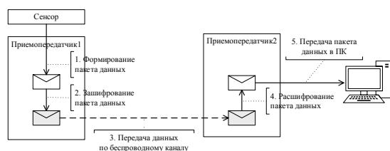
Рисунок 1 – Схема зашифрованной передачи информации в сенсорной сети
