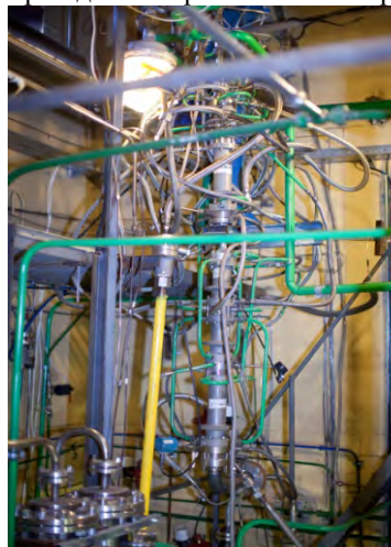
Рисунок 3 – Высокотемпературная установка для получения водорода
