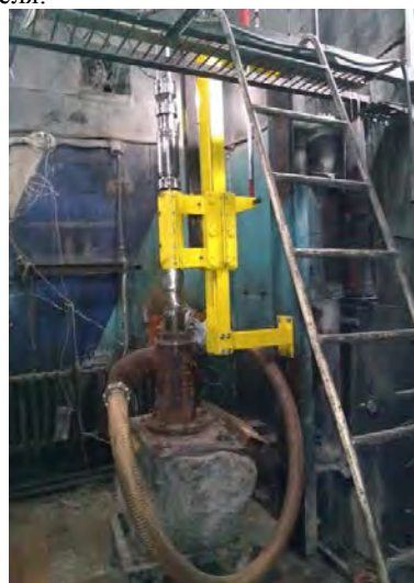
Рисунок 5 – Экспериментальный стенд с опытным образцом парогазогенератора
