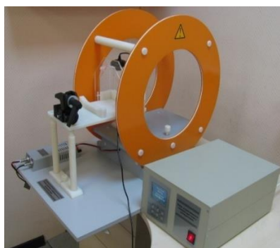
Рисунок 1 – Внешний вид национального эталона единицы напряженности магнитного поля НЭ РБ 59-20
