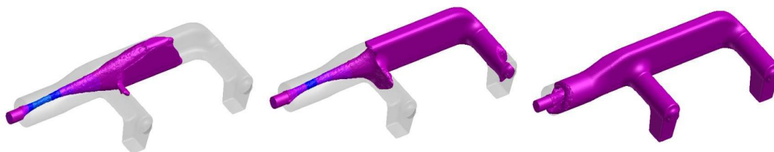
Рисунок 6 - Заполнение полости формы стержневой смесью (способ 4)
