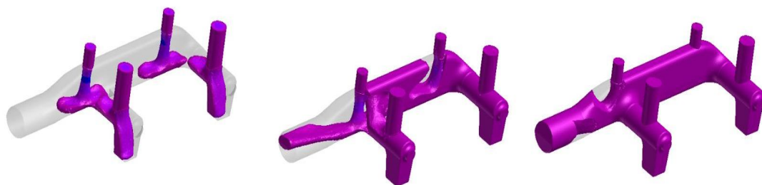
Рисунок 3 - Заполнение полости формы стержневой смесью (способ 1)
