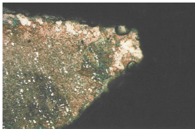
Рисунок 2 – Микроструктура обезуглероженного слоя стали 95X18
