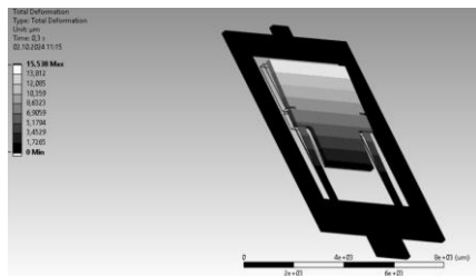
Рисунок 3 – Максимальная отклонение инерционной массы, ширина подвеса 500 мкм, толщина 30 мкм
