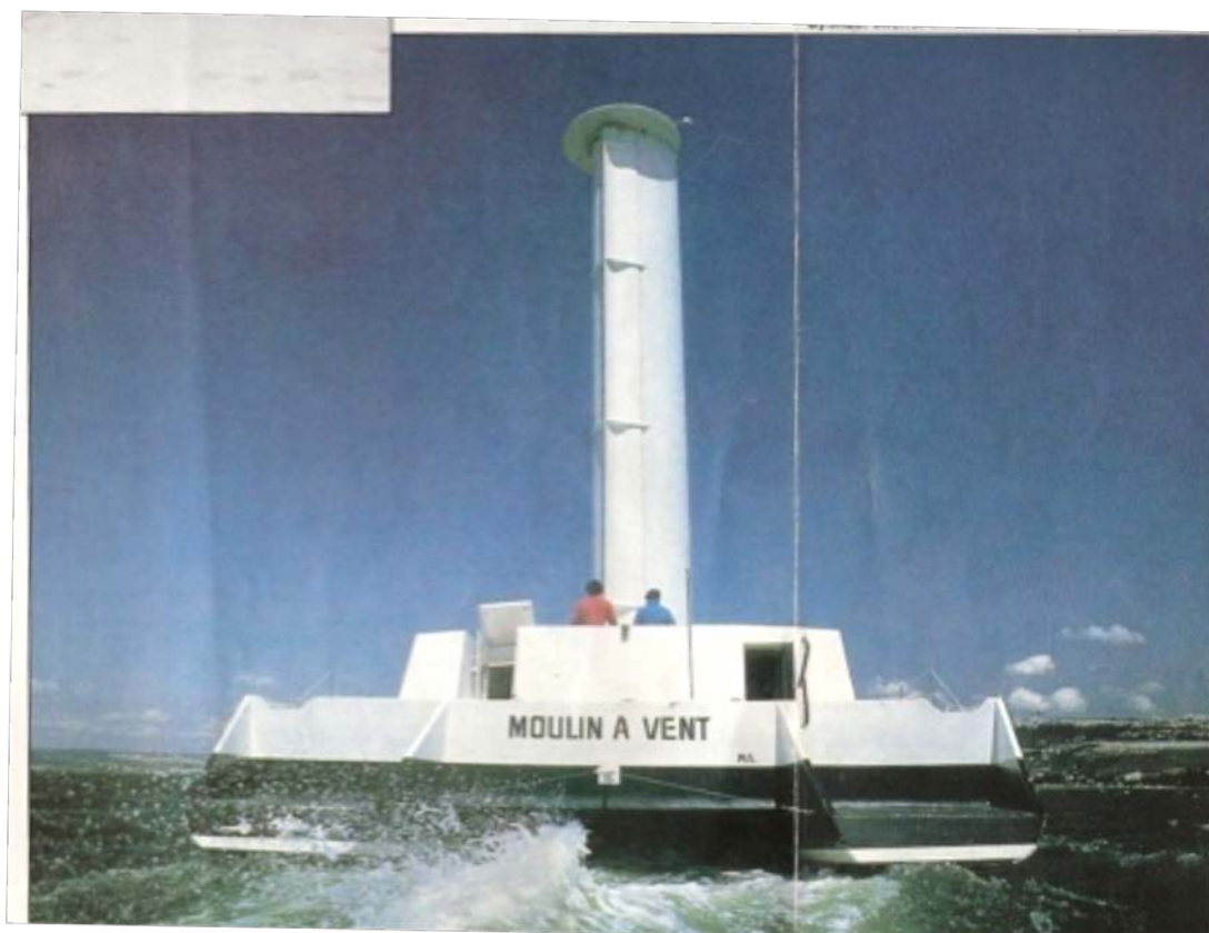
Рисунок 5 – Катамаран «Ветряная мельница» (Moulin à Vent) с турбопарусом, 1981г
