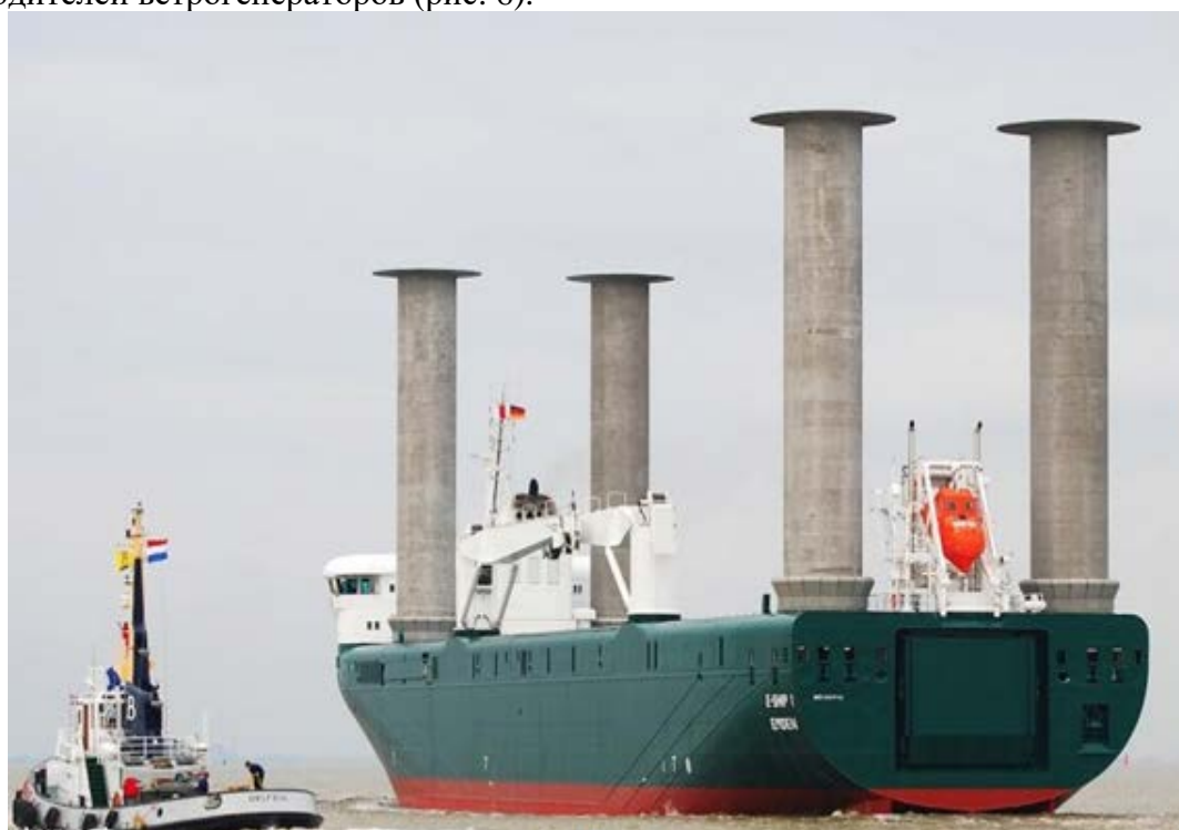
Рисунок 6 – Грузовой корабль с роторными парусами E-Ship 1, 2010г
