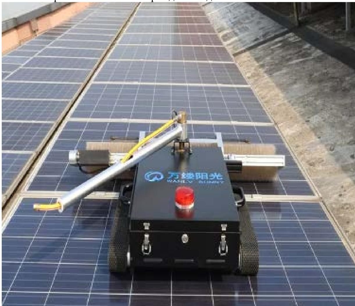
Рисунок 2 – Очистка солнечной панели с помощью робота
