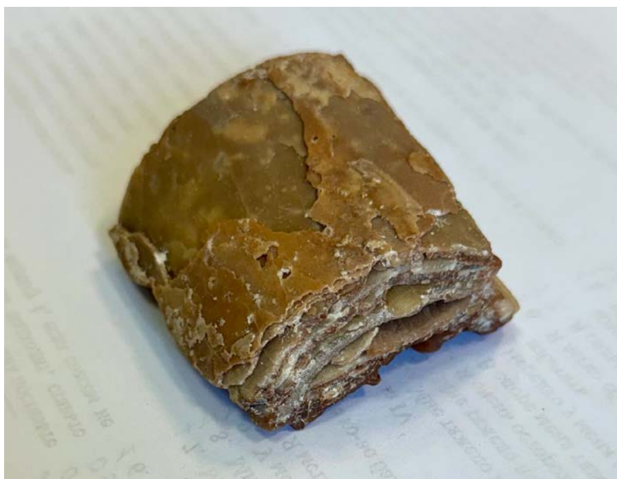
Рисунок 5 – Фрагмент отложений в трубопроводах
