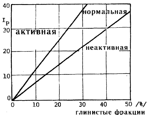
Рис.1. Активность суглинков в зависимости от содержания глинистых фракций и числа пластичности по Скемptonу.
