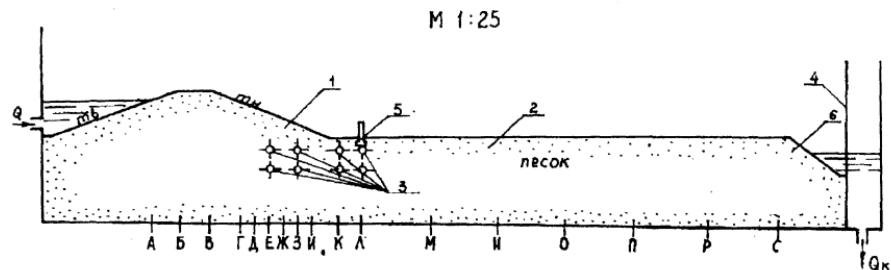
Рис.2. Положение уровней грунтовых вод на защищаемой территории: 1 – при обычной конструкции защитного дренажа; 2 – при устройстве дренажа с водонепроницаемой завесой.
