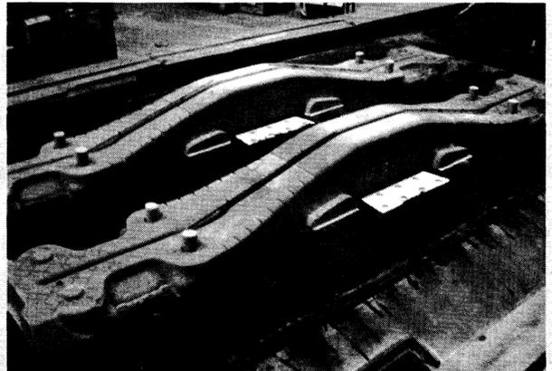
Рис. 7. «АЗОВМАШ». Сборка форм для отливок «Рама боковая» и «Балка наддресорная»
