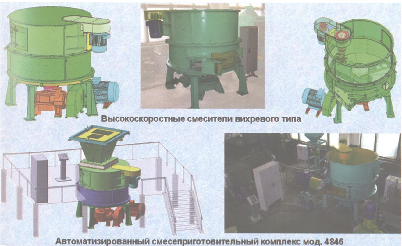
Рис. 3. Оборудование для приготовления формовочной песчано-глинистой смеси
