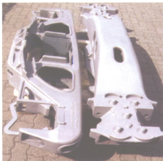
Рис. 14. Отливки по V-процессу, изготовленные на заводе в Китае
