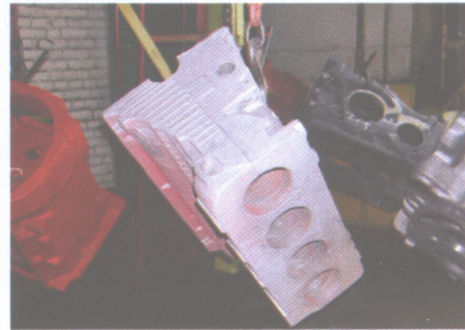
Рис. 5. Стержни отливки «Блок цилиндров», изготовленные по технологии Cold-box-amin
