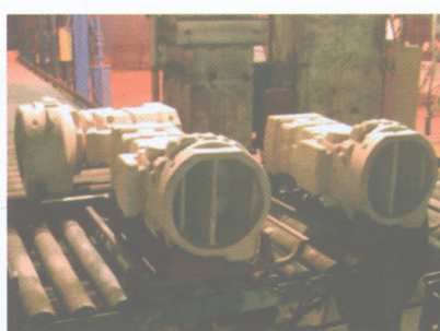
Рис. 6. Стержни отливки «Муфта сцепления», изготовленные по технологии Cold-box-amin
