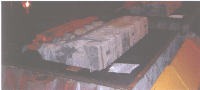
Рис. 5. Стержни отливки «Блок цилиндров», изготовленные по технологии Cold-box-amin
