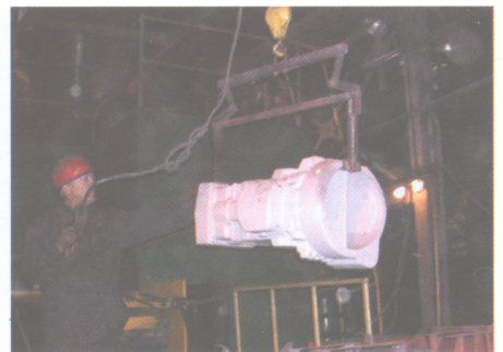
Рис. 5. Стержни отливки «Блок цилиндров», изготовленные по технологии Cold-box-amin
