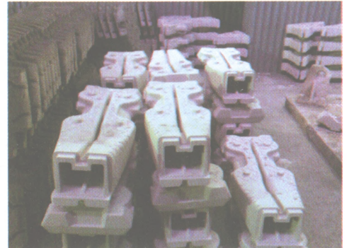
Рис. 9. «АЗОВМАШ». Изготовление стержней по Cold-box-amin-технологии для отливки «Балка наддрессорная»
