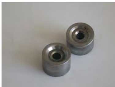
Рисунок 7 – Сборные твердосплавные фильеры, изготовленные методом ЭКС
