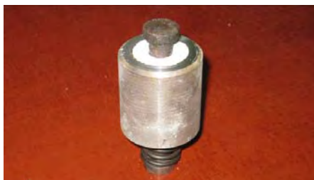
Рисунок 6 – Пресс-форма для электроконтактного спекания твердосплавной фильеры
