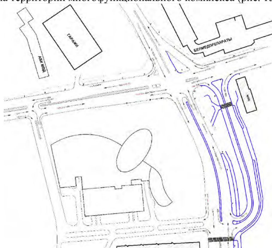
Рис. 13 – Пример схемы распределения перспективной интенсивности движения транспорта проектируемого объекта
