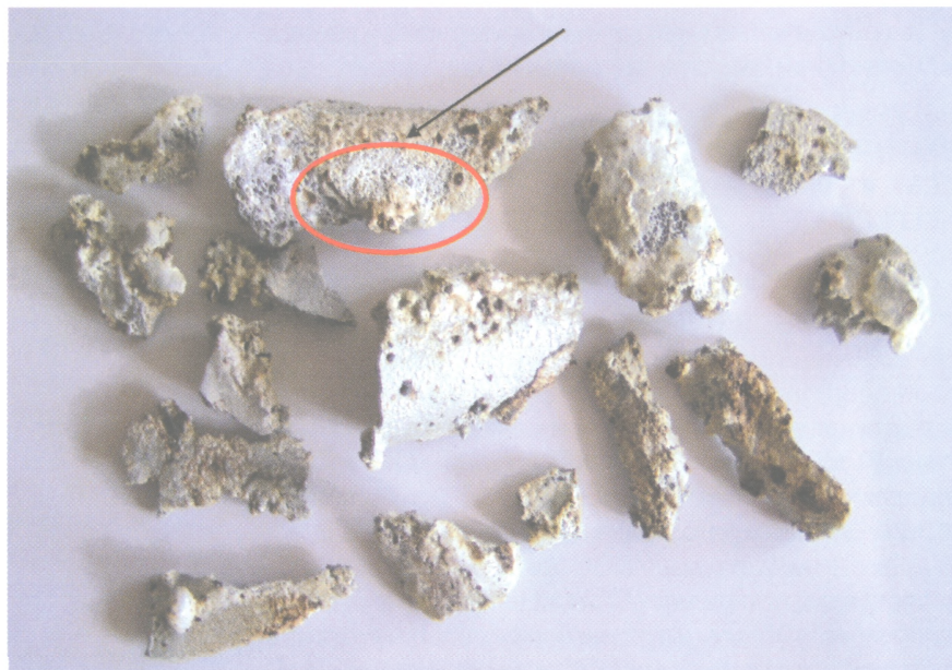
Рис. 7. Основной шлак с высокой сульфидной емкостью (содержание серы в шлаке составляет более 1%). Желтый цвет указывает на протекание процесса десульфурации
