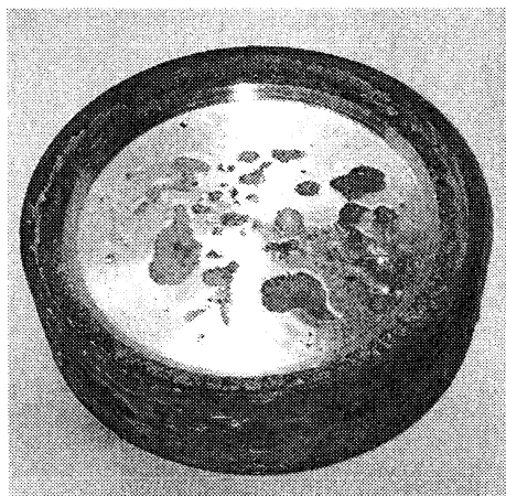
Рис. 2. Биметаллическая отливка сталь – алюминиевая бронза
