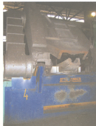
Индукционная печь средней частоты Otto Junker (6 т)
