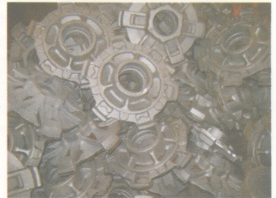
Отливка "Ступица колеса"
