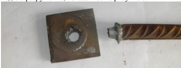
Рис. 8. Соединения типа Т12-Рз после испытаний (брак)
