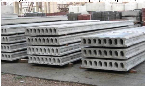
Рис. 1. Многупустотные плиты безопалубочного формования
