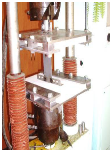
Рис. 3. Испытание фрагмента несъемной опалубки из ЦСП
