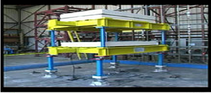
Рис. 7. Фрикционно-маятниковая опора: вибро-испытание
