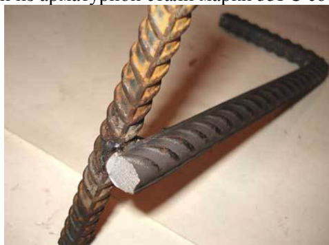
Рис. 2. Разрушение крестообразных соединений арматуры из арматурной стали марки 35ГС
