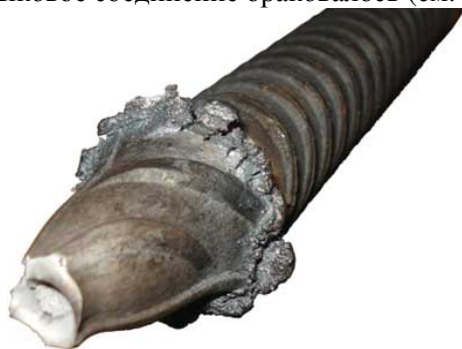
Рис. 5. Соединение типа С1-Ко после испытаний
