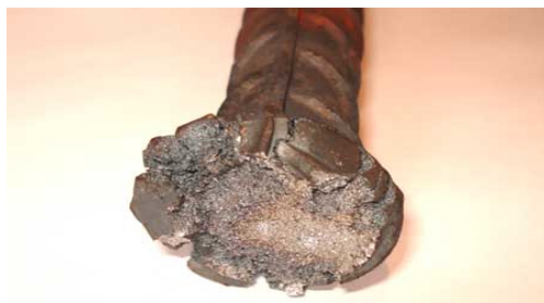
Рис. 6. Соединения типа С1-Ко после испытаний (брак)
