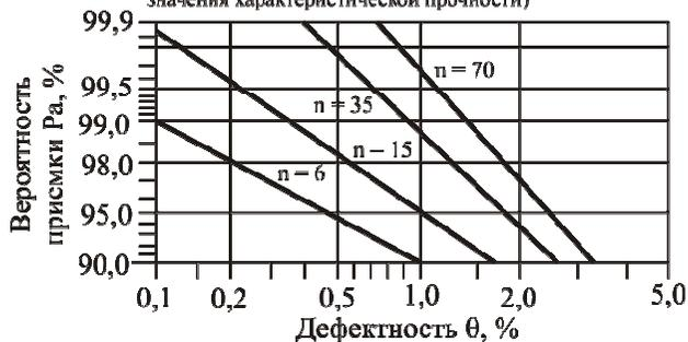
Рис. 3 – Влияние количества единичных результатов испытаний  $n$ , на положение линейризованных операционных кривых (ОС-кривых) для критериев постоянного производства, принятых в EN-206-1, согласно [30]
