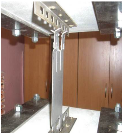
а – раскрытие металлического замка; б – выдёргивание крепёжных шурупов из ЦСП
