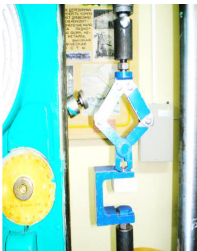
Рис. 2. Приспособление для выдергивания шурупов
