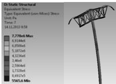
Рисунок 1. Геометрическая модель каркаса навеса под нагрузкой (слева) и результаты оптимизации (справа)
