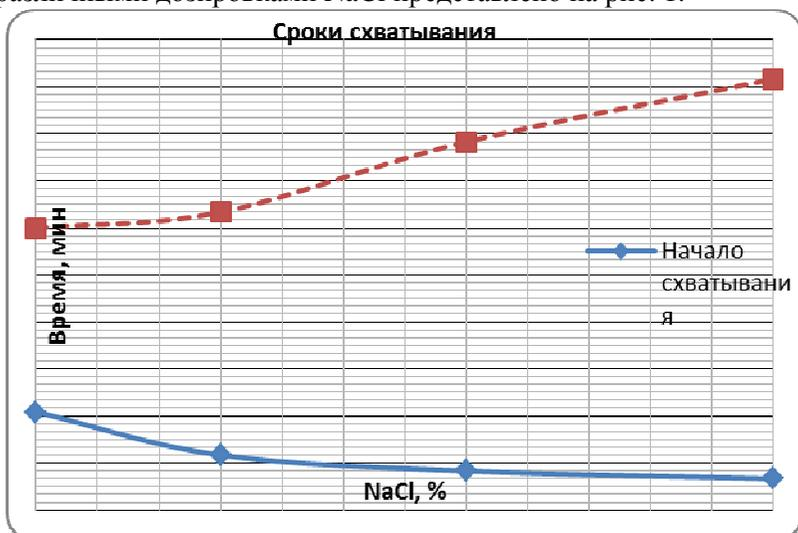
Рис. 1. Изменение сроков схватывания цементного теста с различным содержанием NaCl
