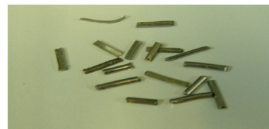
Рис. 7. Образцы лигатуры, полученные экструзией, на основе олова с добавками нанодисперсных порошков
