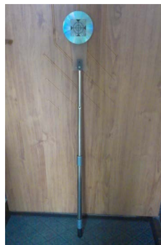
Рис. 2. Переносная светоотражательная диск-марка
