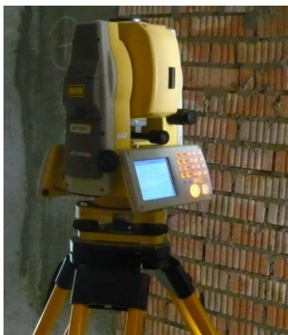
Рис. 1. Электронный тахеометр в положении измерения зенитных углов
