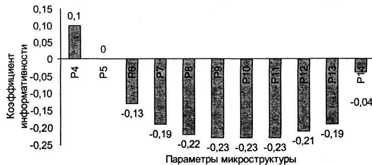
Рис. 8. Гистограмма коэффициентов информативности (парной корреляции) между относительным сужением и спектральными характеристиками микроструктуры
