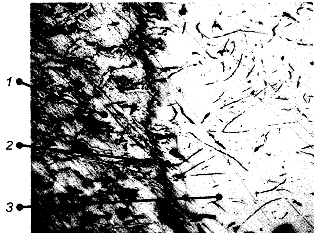
Рис. 5. Микроструктура вставки, алитированной по оптимальному режиму и залитой алюминиевым расплавом: 1 – алюминиевый сплав; 2 – переходный слой; 3 – нирезист
