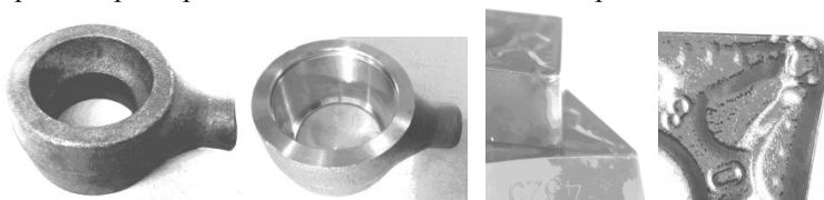
Рисунок 1 – Заготовка, деталь и нормальный износ пластины
