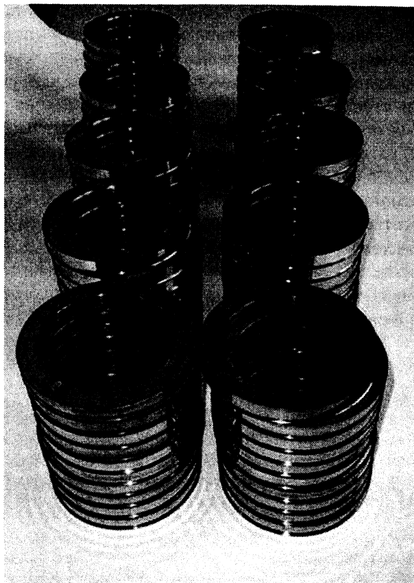
Рис. 4. Опытная партия деталей «Диск тормозной» из БВХЧ
