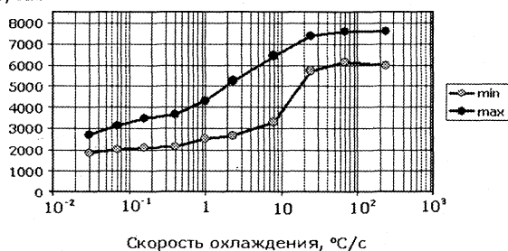
Рис. 2. Микротвердость стали 42Cr4Mo2 после охлаждения с различными скоростями
