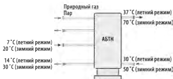
Рис. 8. Использование одной и той же установки в качестве АБХМ и АБТН
