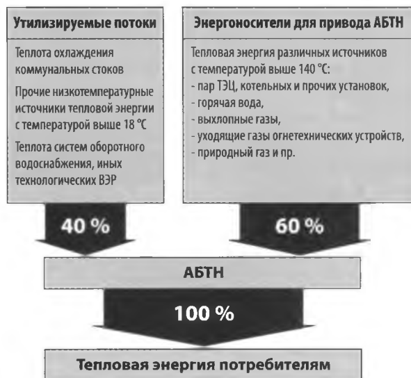
Рис. 4. Тепловые потоки АБТН и их соотношение
