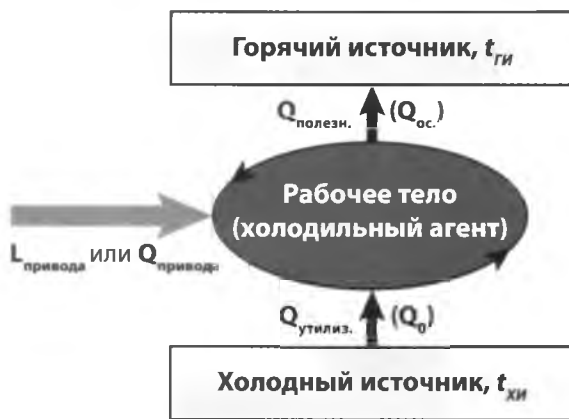
Рис. 1. Принципиальная схема установок обратного цикла
