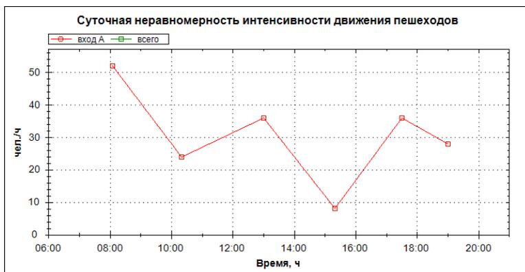
**Рисунок 5** – Суточная неравномерность интенсивности движения пешеходов
