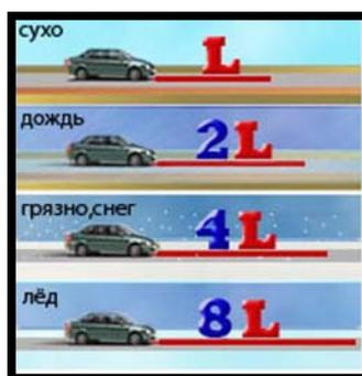
Рис.1 – Изменение тормозного пути в зависимости от состояния покрытия
