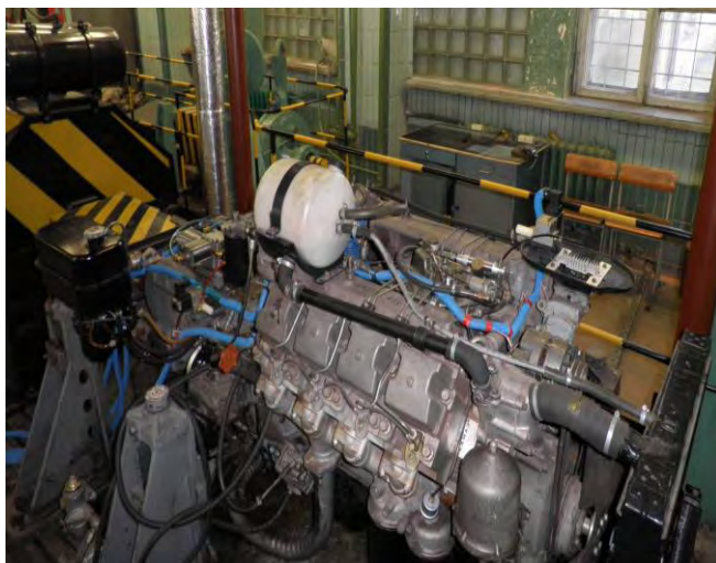
Рис. 3.1. Общий вид стенда с АМС управления силовым агрегатом
