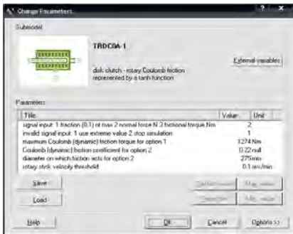
Рис. 2.7. Параметры субмодели TRDC0A сухого фрикционного сцепления
