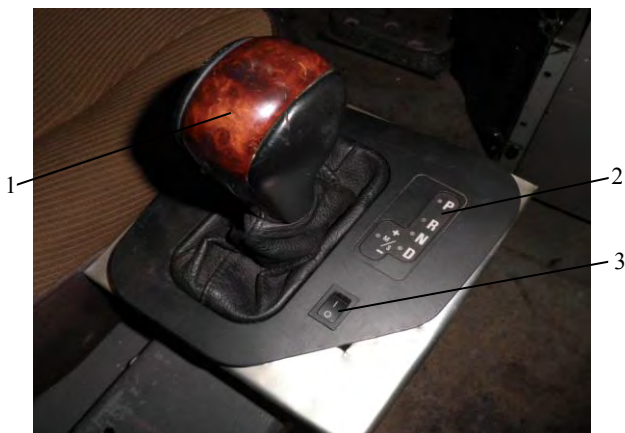
Рис. 3.53. Селектор режимов работы силового агрегата:
