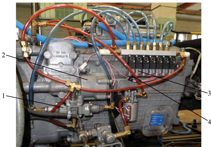
Рис. 3.32. Исполнительный механизм делителя с системой управления: 1 – воздухораспределитель золотникового типа; 2 – силовой цилиндр; 3, 4 – электромагнитные клапаны управления делителем
