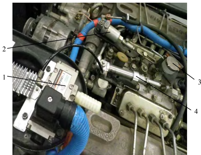
Рис. 3.14. Размещение пневмоцилиндра, ПЭМК и датчика МУ-615А на двигателе: 1 – пропорциональный ЭМКВЕР3121; 2 – пневмоцилиндр выключения подачи топлива; 3 – датчик МУ-615А перемещения рычага регулятора ТНВД; 4 – силовой пневмоцилиндр
