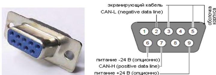
Рис. 3.42. Внешний вид и распиновка разъема DB9
