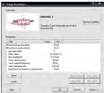
Рис. 2.9. Параметры субмодели PNPV001 пропорционального ЭМК
