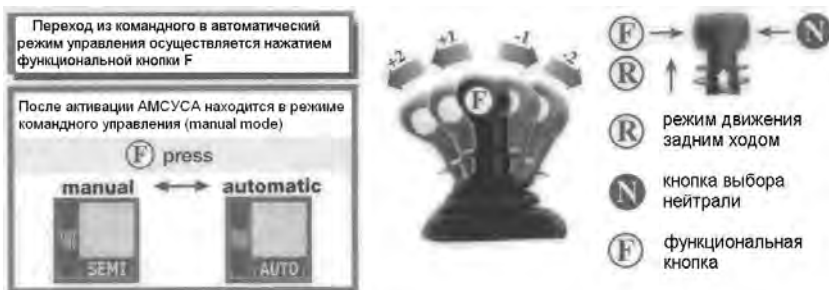
Рис. 1.4. ЖКИ-монитор и рычаг-джойстик АМСУСА EuroTronic automated
