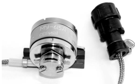
Рис. 3.13. Потенциометрический датчик угловых перемещений МУ-615А
