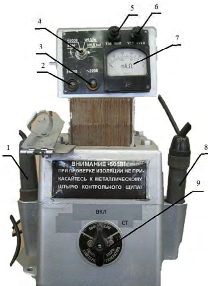
Рис. 1.10. Прибор проверки якорей ППЯ-5:
