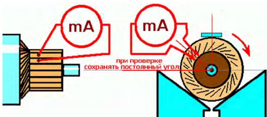
Рис. 1.13. Проверка ЭДС индукции якоря с помощью миллиамперметра
