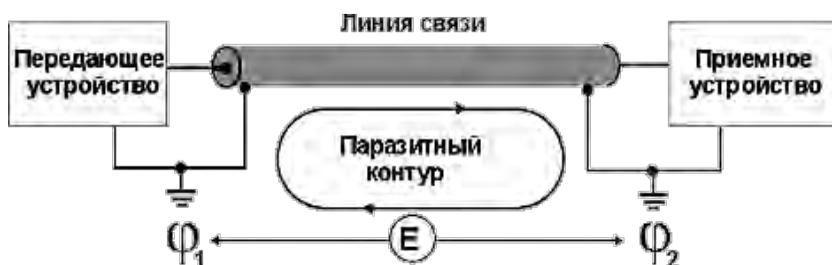
Рис. 1.8. Образование паразитного контура при нескольких точках "зануления"
