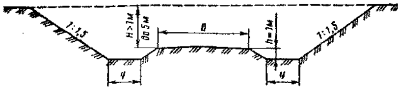
Рис. 6.1. Схема выемки с дополнительной полкой.
