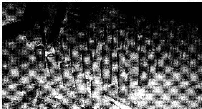
Рис. 1. Охлаждение отливок на воздухе
