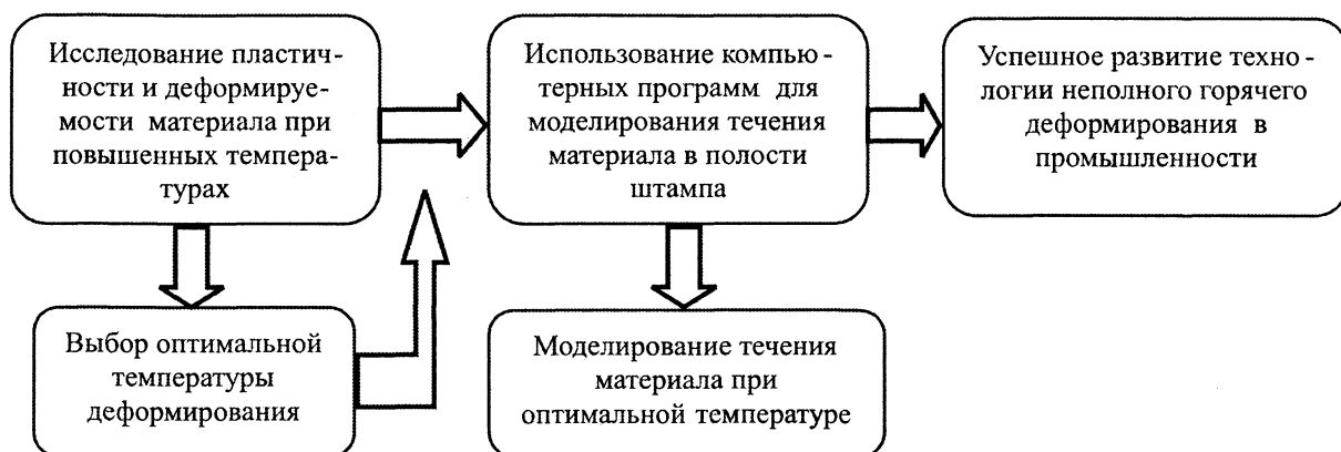
Рис. 4. Схема организации технологического процесса неполного горячего деформирования
