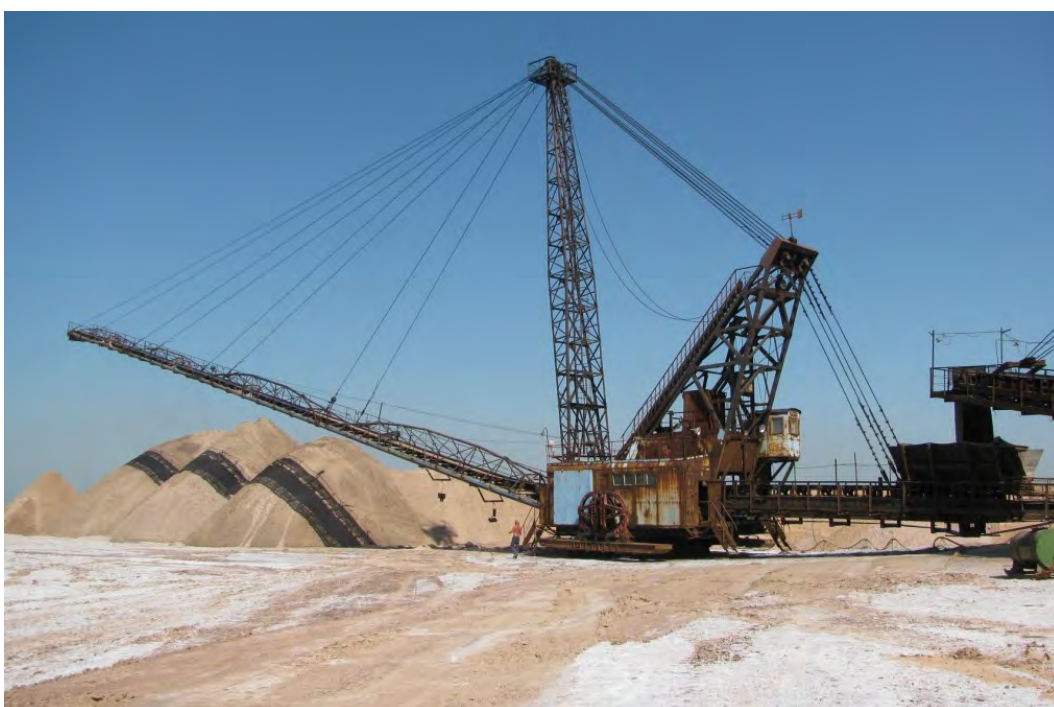
Рисунок 1 - Общий вид отвалообразователя ОШ-75
