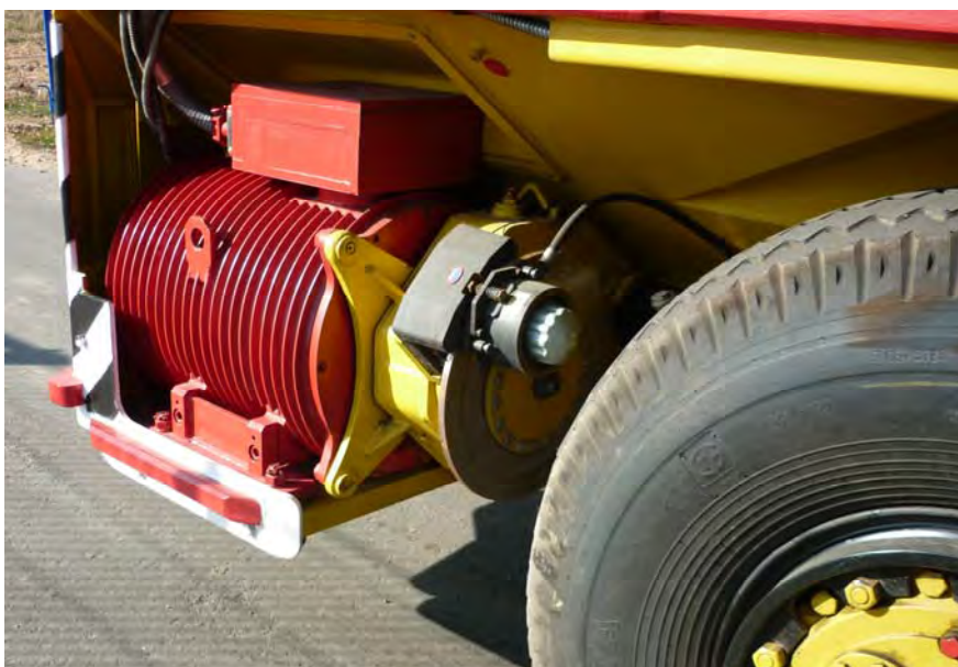
Рисунок 1 – Привод колес шахтного самоходного вагона ВС-17
